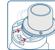
Poussez dans la direction de la flèche, pour ouvrir en faisant glisser le capuchon supérieur.
